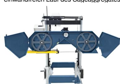
Einfacher Sägebandwechsel durch aufklappbare Abdeckungen
