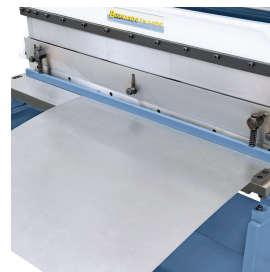
Beim Schneiden wird das Werkstück automatisch geklemmt.
