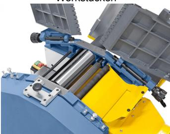
Die dynamisch ausgewuchtete 3-Messerwelle garantiert durch den vibrationsfreien und ruhigen Lauf beste Hobelerggebnisse
