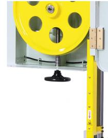
Die Einstellung der Blattspannung erfolgt mittels Handrad.
