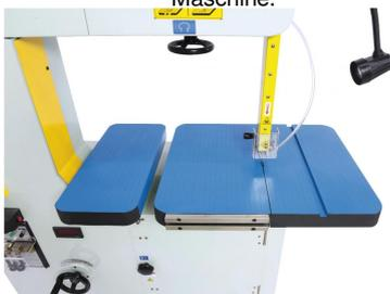
Kugelgelagerte Sägebandführung, einstellbar auf die jeweilige Werkstückhöhe.
