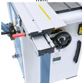
Der großzügig dimensionierte Formattisch läuft leichtgängig auf einer gehärteten Prismenführung.
