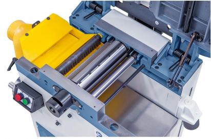
Das Hobelwerk besteht aus einer dynamisch ausgewuchteten 3-Messerwelle, einer Ein- und Auszugswalze, sowie massiven Rückschlagsicherungen.
