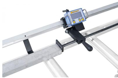
Hochklappbarer Materialanschlag, wahlweise rechts oder links verwendbar
