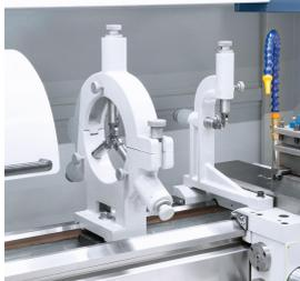
Zum Stabilisieren von langen Werkstücken serienmäßig mit einer feststehenden bzw. mitlaufenden Lünette ausgestattet.
