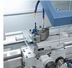
Der Schnellwechselstahlhalter ermöglicht eine Reduzierung der Nebenzeiten und gewährleistet eine hohe Wiederholgenauigkeit.
