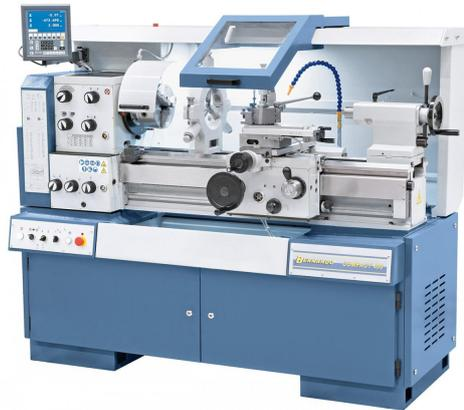
Die Präzisionsdrehmaschine Compact 400 ist eine moderne, dem heutigen Stand der Technik entsprechende Maschine. Schon die Grundausstattung beinhaltet alle wichtigen Zubehöre (3-Achs-Digital-anzeige, Lünetten, LED-Maschinenleuchte, Sicherheitseinrichtungen nach CE-Norm, ...), wodurch diese Maschine universell einsetzbar ist. Durch die große Bedienungsfreundlichkeit eignet sie sich besonders für Lehrwerkstätten, dem Ausbildungsbereich und Schulen.
