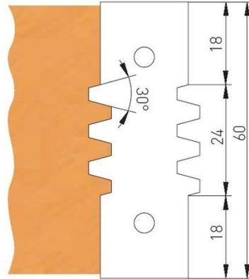
HW-Wendeplatten-Trapez-Verleimfräser Anwendung: Für selbsthemmende Verleimverbindungen in Hart- und Weichholz. Für Tischfräsen mit Handvorschub geeignet. Ausführung: Grundkörper aus Stahl oder hochwertiger Aluminium-Legierung, ausgerüstet mit zwei HW-Profilwendeplatten, doppelseitig profiliert, nur umfangsschneidend, formschlüssig, spandickenbegrenzt, rücksschlagarm. 0
