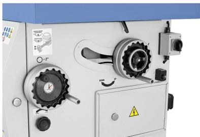
Die Schwenkung des Fräsaggregates erfolgt mittels ergonomisch angebrachtem Handrad, die Gradeinstellung ist auf einer Digitalanzeige ablesbar.
