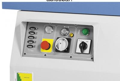
Die Bedienung der Elektrokomponenten erfolgt bequem an der Frontseite der Maschine. LED's zeigen die eingestellte Drehzahl an.
