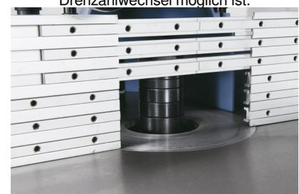
Die Integral-Sicherheitschienen aus eloxiertem Aluminium lassen sich individuell an jede Fräserform anpassen und gewährleisten
