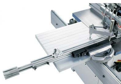
Durch den optionalen Rolltisch mit ausziehbarem Teleskopanschlag und Exzentrerspanner wird der Einsatzbereich
