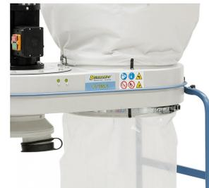
Einfache Montage des Späne- bzw. Filtersackes mittels Spanngurt
