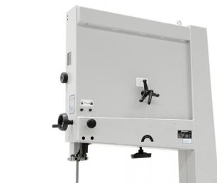
Inklusive Präzisions-3-Rollen-Sägebandführung über und unter dem Säge Tisch
