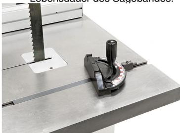
Der serienmäßige Gehrungsanschlag ist von -60° bis +60° verstellbar und wird in der T-Nut des Arbeitstisches geführt.
