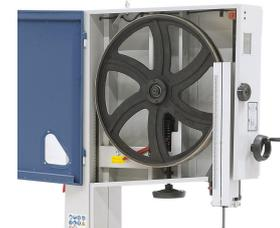
Die Einstellung der Blattspannung erfolgt mittels Handrad und wird über ein Diagramm am oberen Laufrad angezeigt.
