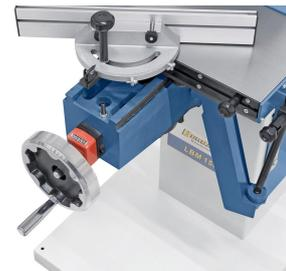
Die Höhenverstellung des Arbeitstisches erfolgt leichtgängig und präzise mittels Handrad.
