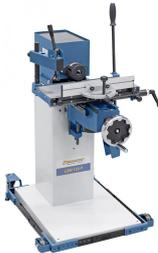
Das optional erhältliche Universalfahrwerk ermöglicht einen leichten Standortwechsel.
