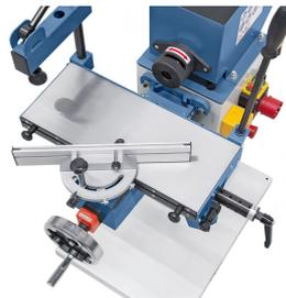
Verstellbarer Gehrungsanschlag, 2 x 60° schwenkbar.
