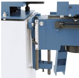
Die eingestellte Arbeitshöhe des Bohrtisches wird mittels Skala abgelesen.
