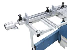
Der über die gesamte Schlittenlänge verschiebbare, massive Auslegertisch kann in jeder Position abgenommen werden. Der ausziehbarer Teleskopanschlag mit 2 massiven Klappanschlägen ist millimetergenau
