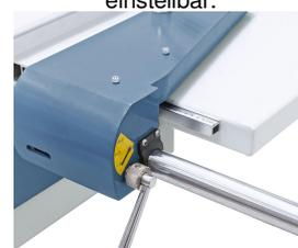
Der mit einer mikrometrischen Feineinstellung ausgerüstete Parallelanschlag kann für Schnittbreiten bis 1295 mm verwendet werden
