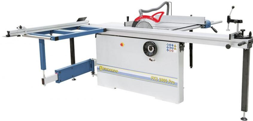
Die Formatkreissägen der FKS-Serie sind je nach Anwendung wahlweise mit drei verschiedenen Tischlängen lieferbar (2600 / 2800 / 3200 mm). Serienmäßig ausgestattet mit einem 3,8 kW Motor und einem Sägeblatt mit 315 mm Durchmesser für Schnitthöhen bis 100 mm, sowie einem Vorritzaggregat für ein ausreißfreies Bearbeiten beschichteter Plattenwerkstoffe.
