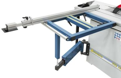
Auslegertisch mit Rolle für vereinfachtes Handling bei größeren Werkstücken.
