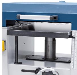
Der verwindungsfreie Dickentisch ist mit einer mittigen Säule geführt und zusätzlich abgestützt.
