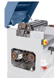
Der Vorschub des Werkstückes erfolgt über einen stabilen Kettenantrieb. Die Vorschubgeschwindigkeit beträgt 5 - 7 m/min.
