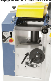
Dickentisch mit mittiger Säulenführung und Abstützung für plangenaues Hobeln.
