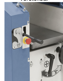
Vorschub ist zum Abricht Hobeln ausschaltbar.
