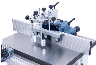
Die Fräseschutzhaube ist mit eloxierten Aluminium-Anschlagsschienen ausgestattet.
