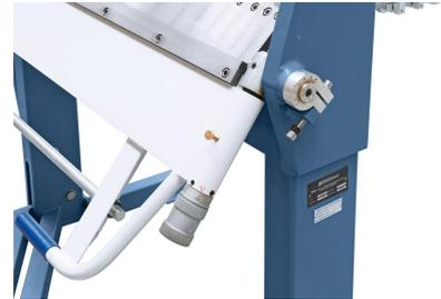
Die Einstellung der gewünschten Materialstärke erfolgt schnell und einfach mittels Einstellschrauben.
