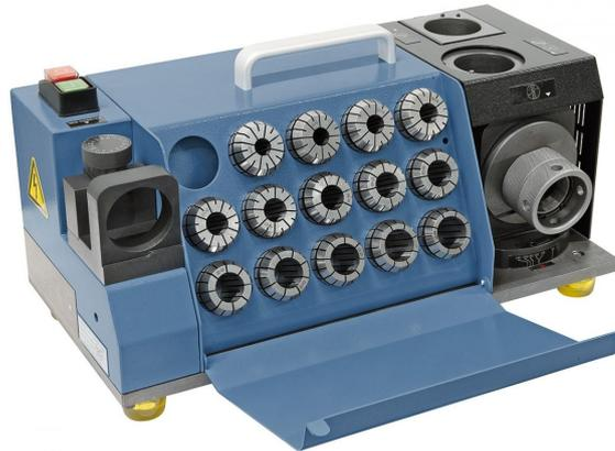
Die Bohrerschleifmaschine DG 32 MD ist für alle gängigen 2-schneidigen Spiralbohrer aus HSS, Kobalt oder Hartmetall und dergleichen von 8 – 32 mm geeignet. Der Vorteil dieses Modells ist die Möglichkeit zum Hinterschleifen der Schneidflächen, wodurch ein perfektes Bohrerergebnis gewährleistet wird.
