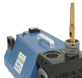
Hinterschleifen des Freiwinkels
