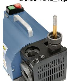
Hinterschleifen des Freiwinkels
