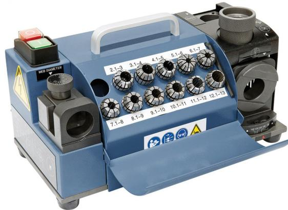
Die handliche Bohrerschleifmaschine DG 13 MD ist ideal zum Schleifen von Spiralbohrern aus HSS, Hartmetall, Kobalt usw. Der Vorteil dieses Modells - im Vergleich zur DG 13 M - ist die Möglichkeit zum Hinterschleifen der Schneidflächen, wodurch ein perfektes Bohrerergebnis gewährleistet wird.
