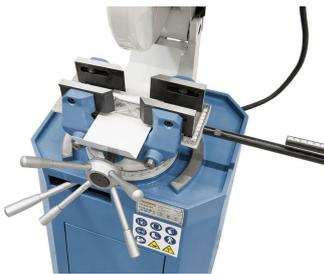
Zentrisch spannender Schraubstock mit längsverschiebbaren Spannbacken.
