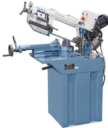
Die kostengünstige Horizontalbandsäge MCB 210 eco mit umfangreicher Grundausstattung (Untergestell, Kühlmittleinrichtung, Sägeband, ...) ist die ideale Maschine für den kostenbewussten Anwender. Der Sägebügel ist bis 60° schwenkbar, dadurch ermöglicht dieses Modell ein platzsparendes Arbeiten bei langen Werkstücken.
