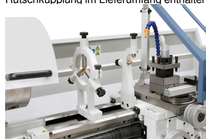
Zum Stabilisieren von langen Werkstücken serienmäßig mit einer feststehenden bzw. mitlaufenden Lünette ausgestattet.
