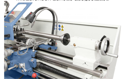
Zentrierkegel diam. 100 mm, ideal zum Spannen von Röhren und Hohlkörpern (Option)
