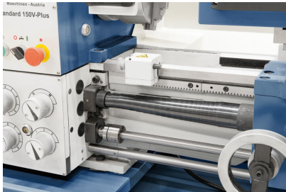
Mikrometerlängsanschlag und Rutschkupplung im Lieferumfang enthalten
