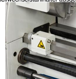
Serienmäßig mit Rutschkupplung und Mikrometerlängsanschlag ausgestattet
