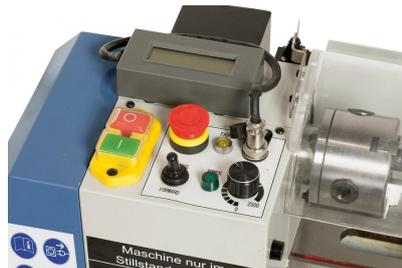
Zum exakten Einstellen der gewünschten Drehzahl kann die Maschine mit einer digitalen Drehzahlanzeige ausgestattet werden.
