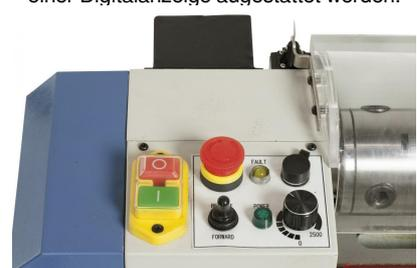
Die Spindeldrehzahl ist stufenlos einstellbar, serienmäßig mit Rechts-Linkslauf ausgestattet.
