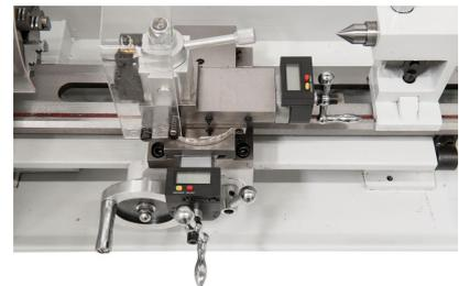
Für ein einfaches Ablesen des Verfahrensweges kann der Querschlitzen bzw. Obersupport mit einer Digitalanzeige ausgestattet werden.
