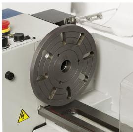
Zum Aufspannen von speziell geformten Werkstücken kann die Maschine mit einer 160 mm Aufspannscheibe ausgerüstet werden.
