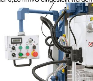
Einfache Vorwahl der Drehzahlstufe mittels Getriebewahlschalter, einstellen der gewünschten Drehzahl mittels Potentiometer.
