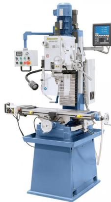
Die Bohr- und Fräsmaschine FM 55 HSV Vario zeichnet sich neben der motorischen Höhenverstellung des Fräskopfes und dem automatischen Pinolenvorschub vor allem durch die stufenlose Drehzahl aus. Schon die Grundausrüstung beinhaltet alle wichtigen Zubehöre (3-Achs-Digitalanzeige, Frästischvorschub, Zentralschmierung, Kühlmiteleinrichtung, LED-Arbeitsleuchte, Graugussuntergestell mit Kühlmittelrinne, Sicherheitseinrichtungen nach CE-Norm, ...), wodurch diese Maschine universell einsetzbar ist.
