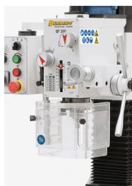
Hohe Sicherheit durch höhenverstellbaren Futterschutz mit Mikroschalter.
