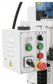
Übersichtlich angeordnete Schaltelemente, serienmäßig mit Gewindeschneideinrichtung.
