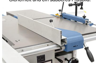
Abklappbarer Parallelanschlag mit mikrometrischer Feineinstellung.
