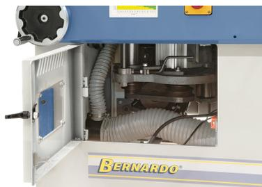
Einfacher Riemenwechsel zur Geschwindigkeitswahl der Frässpindel über großzügige Öffnung an der Maschinenfront.
