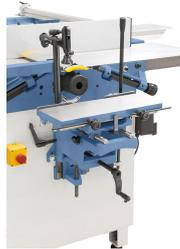
Die serienmäßige Langlochbohrereinrichtung ist ideal für Langlöcher, Dübel- und Schräglochbohrungen,....
