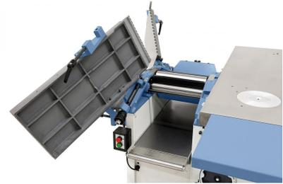
Die hochklappbaren Abrichttische ermöglichen beim Dickenhobeln ein optimales und sicheres Arbeiten, auch bei kurzen Werkstücken.
