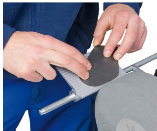
05-2056 Auflagetisch: Optimal zum Schleifen diverser Kleinteile
