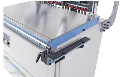
Abschwenkbare Seitenanschlüsse für kurze Umrüstung von Korpus- auf Rahmen- und Lochreihenbohrungen
