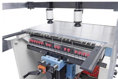
Anschlagfingerleiste mit 3 Aussparungen zur Verwendung von Kombibohrsegmenten für Topfbänder
