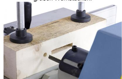
Das Westcott-Bohrfutter kann für Langlochbohrer mit Schaft max. 20 mm verwendet werden
