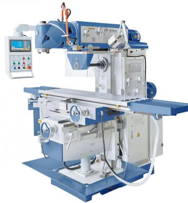
Das Modell UWF 150 Servo ist eine sehr stabil gebaute Universalfräsmaschine mit verschiebbarem Oberarm und großer Tischaufspanfläche. Die großdimensionierten Führungen in allen Achsen garantieren auch bei hoher Tischbelastung ein Höchstmaß an Stabilität und Präzision. Besondere Merkmale dieser Maschine sind der schwenkbare Arbeitstisch, die Flachführung in y- und z-Achse und der Servoantrieb für Vorschübe und Eilgang in allen Achsen.
