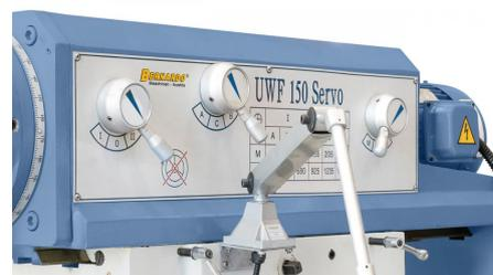
Einfache Bedienung der Schaltelemente für den Drehzahlwechsel
