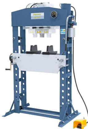
Serienmäßig mit nach links und rechts verschiebbarem Druckzylinder.
