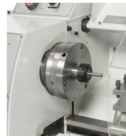
Das Spannzangenfutter ER 25 gewährleistet eine hohe Rundlaufgenauigkeit beim Spannen von Werkstücken, Spannbereich 1 - 16 mm.
