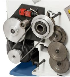
Einfaches Einstellen der Drehzahlstufe mittels Keilriemen
