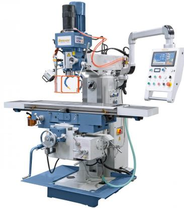
Die Universalfräsmaschine UWF 95 N Vario wurde speziell zum wirtschaftlichen Herstellen von Einzelwerkstücken und kleinen Serien mit hoher Präzision konzipiert. Durch die große Bedienerfreundlichkeit eignet sich dieses Modell besonders für den Maschinenbau, Anlagenbau, Produktion und Einzelteilanfertigung. Weiters ist dieses Modell mit einer variablen Drehzahlregelung der Vertikalspindel für ein optimales Einstellen der Schnittgeschwindigkeit ausgestattet.
