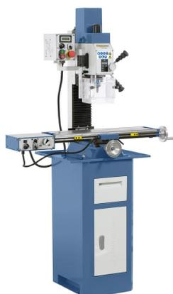
Die Bohr- und Fräsmaschine KF 25 Pro ist aufgrund der hohen Drehzahl bis 3000 U/min, dem leistungsstarken Antriebsmotor (900 W) und der Spindelaufnahme MK 3 das ideale Modell für den anspruchsvollen Anwender. Zur Reduzierung der Fertigungszeiten ist dieses Modell mit einem stufenlos regelbaren Frästischvorschub ausgestattet. Zusätzlich ist dieses Modell auch mit einer 3-Achs-Positionsanzeige lieferbar.
