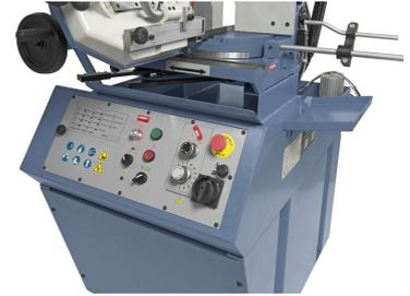
Drehschalter für stufenlose Schnittgeschwindigkeit und Regelventil für den Auflagedruck am ergonomisch angebrachten Bedientableau
