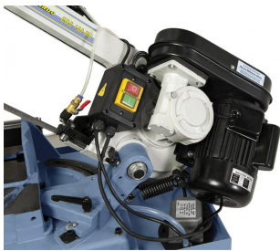
Mittels Keilriemen kann die Schnittgeschwindigkeit (23 / 33 / 52 m/min) gewechselt werden
