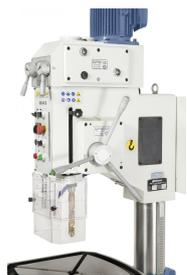
Für präzises Arbeiten ist die Maschine serienmäßig mit einem automatischen Spindelvorschub sowie einer Arbeitsleuchte ausgestattet
