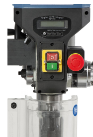
EIN-AUS Schalter nach IP 54 und separater Not-Halt-Taster nach CE-Norm
