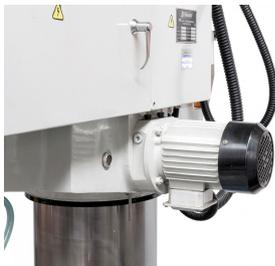
Serienmäßiger Hydraulikmotor für die Klemmung des Auslegerarms und des Bohrkopfes
