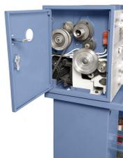
Lieferumfang komplett mit Wechselräder zum Gewindeschneiden
