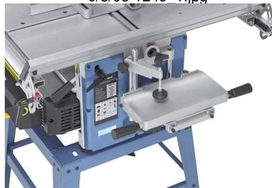
Die serienmäßige Langlochbohreineinrichtung ist unerlässlich für Schlitz- und Bohrarbeiten.
