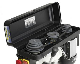
Gewuchtete Grauguss-Antriebsscheiben für hohe Laufruhe, die hochwertigen Keilriemen sorgen für eine optimale Kraftübertragung
